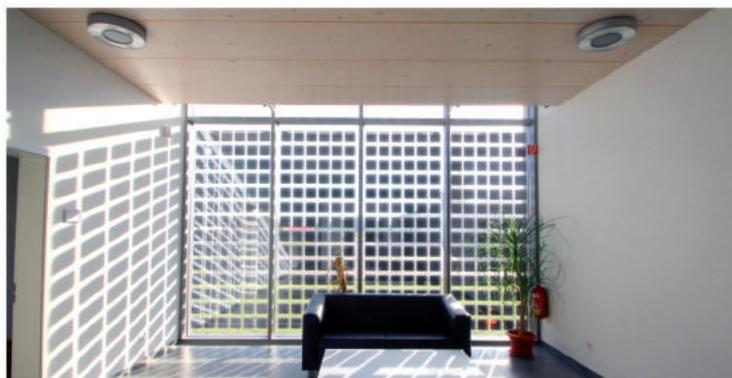
Solarfassade mit Isolierglas in unserer Carport & Terrassendach Produktion Neuruppin mit Klarglas und Solarzellen zur Verbesserung vom sommerlichen Wärmeschutz. Besichtigung nach Terminvereinbarung unter [neuruppin@carportwerk.com](mailto:neuruppin@carportwerk.com) möglich.
